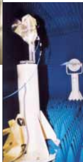
Base de mesure d'antenne.
